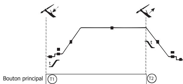
T1 : Die Haupttaste wird gedrückt, der Schweißzyklus beginnt (Gasvorströmung, I\_start, Anstieg und Schweißen).
