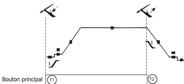
T1 : Quando si preme il pulsante principale, il ciclo di saldatura comincia (Pre-Gas, I\_start, UpSlope e saldatura).
