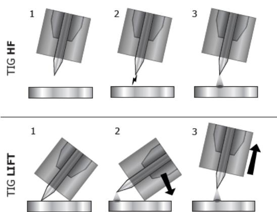
1. Halten Sie den Brenner in der Schweißposition über das Werkstück (Abstand ungefähr 2-3 mm zwischen der Elektrodenspitze und dem Werkstück).
