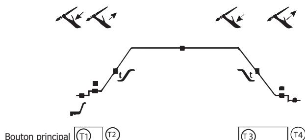
T1 : Die Haupttaste wird gedrückt, der Schweißzyklus beginnt mit der Gasvorströmung und endet mit I\_start.
