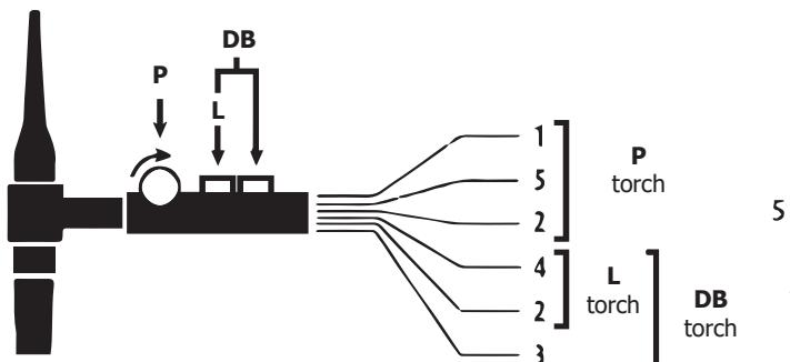
Схема кабельной проводки горелки SRL18
