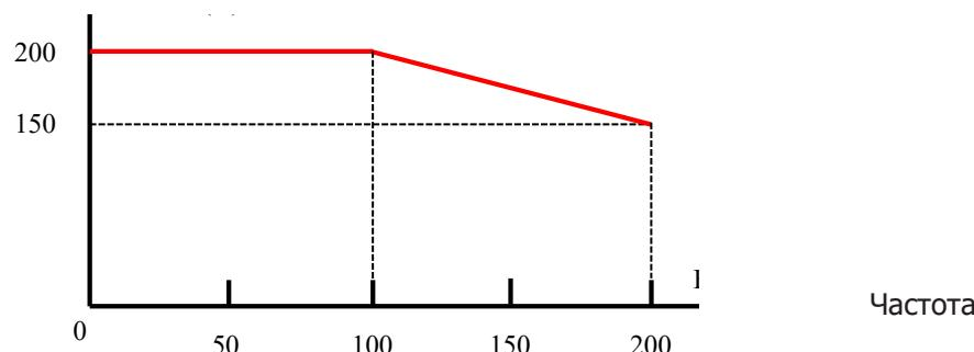
До 100 Гц, сварка возможна при сварочном токе 200 А. Между 100 Гц и 200 Гц максимальное значение сварочного тока уменьшается с 200 А до 150 А.
