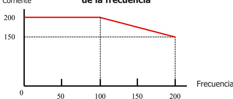
Hasta 100 Hz, es posible soldar a una corriente de soldadura de 200 A. Entre 100 Hz y 200 Hz, la valor máxima de corriente de soldadura baja de 200A a 150A.
