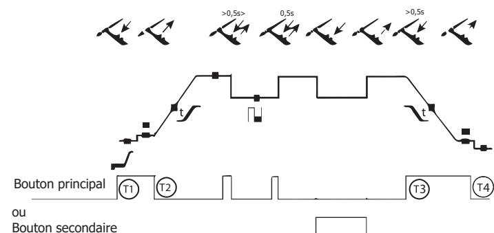
T 1 - Главная кнопка нажата, сварочный цикл начинается с ПредГаза и прекращается на этапе I\_Start.
