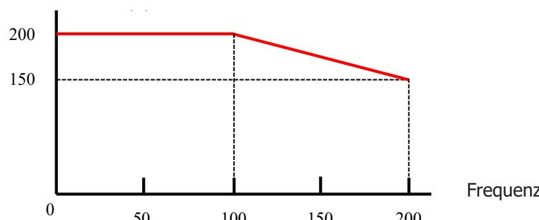
Bis zu 100 Hz Schweißfrequenz beträgt die maximale Schweiß-Stromstärke 200 A. Von 100 Hz bis 200 Hz sinkt die maximale Stromstärke von 200 A auf 150 A.
