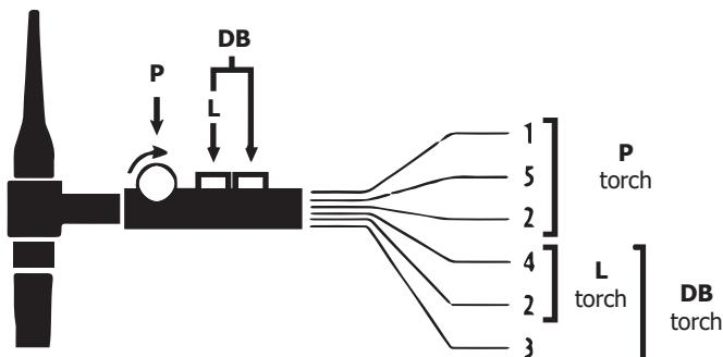
Esquema de cableado de la antorcha SRL 18
