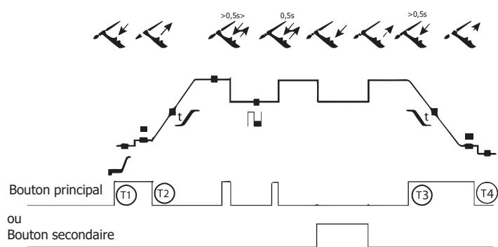
T1 : Le bouton principal est appuyé, le cycle démarre à partir du Pré-Gaz et s'arrête en phase de I\_start.
