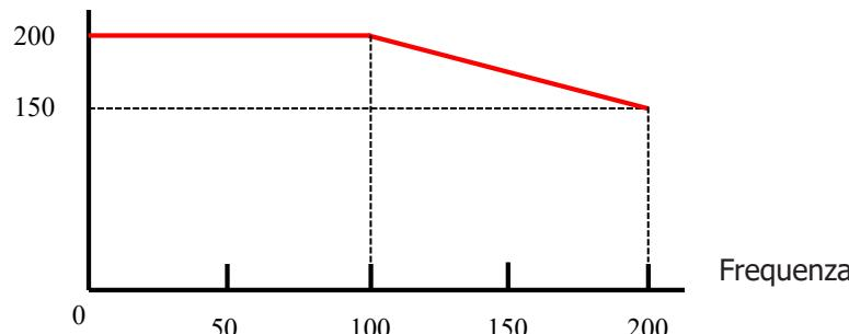
Fino a 100 Hz, è possibile saldare in corrente di saldatura di 200 A. Tra 100 Hz e 200 Hz, il valore ottimale della corrente di saldatura diminuisce da 200 A a 150 A.
