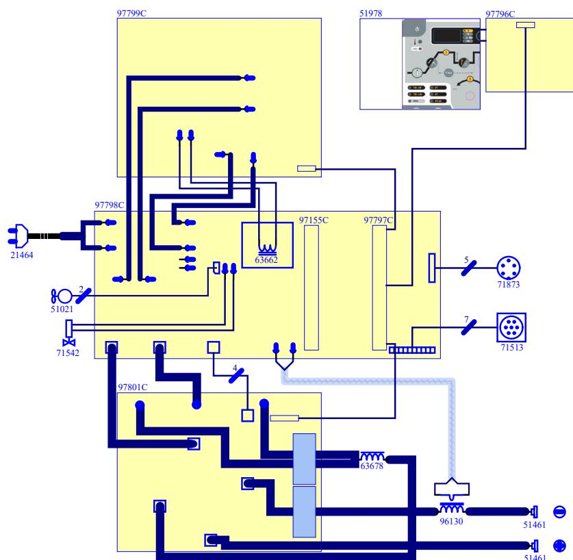
SCHÉMA ÉLECTRIQUE TIG PRO 201 L AC/DC/ CIRCUIT DIAGRAM /SCHALTPLAN/
