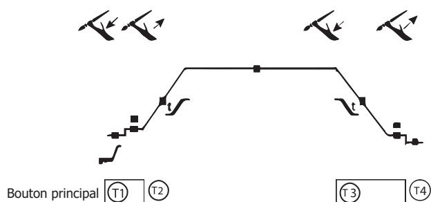
T1 : Le bouton principal est appuyé, le cycle démarre à partir du Pré-Gaz et s'arrête en phase de I\_start.
