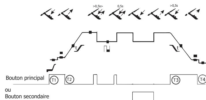
T1 - Al presionar el botón principal, el ciclo de soldadura inicia a partir del pregas y se detiene en la fase de I\_Start
