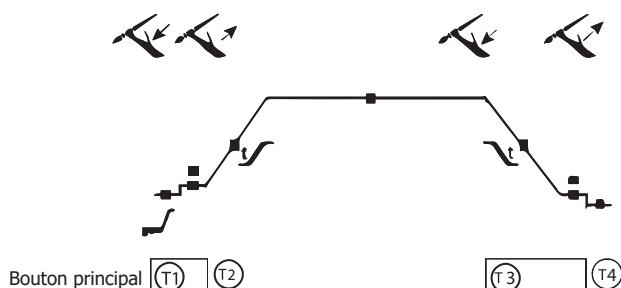
T1 - Al presionar el botón principal, el ciclo de soldadura inicia a partir del pregas y se detiene en la fase de I\_Start
