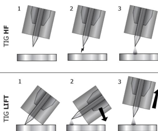
1. Posizionare la torcia nella posizione di saldatura sopra il pezzo (circa 2-3 mm di spazio tra la punta dell'elettrodo e il pezzo).
