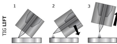
1. Positionner la buse de la torche et la pointe de l'électrode sur la pièce et actionner le bouton de la torche.
