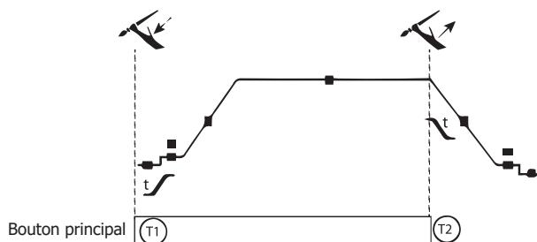
T1 : El botón principal se presiona, el ciclo de soldadura inicia (Pre-Gas, I\_start, UpSlope y soldadura).
