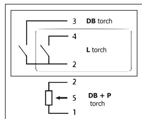
Schema di cablaggio della torcia SRL18
