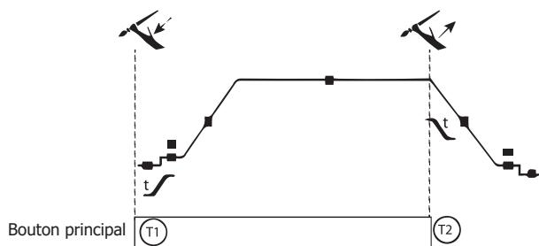
T1: нажата основная кнопка, цикл сварки запускается (Pré-Gaz, I\_start, UpSlope и сварка).
