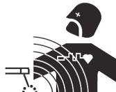
Der durch einen Leiter fließende elektrische Strom erzeugt lokale elektrische und magnetische Felder (EMF). Der Schweißstrom erzeugt ein elektromagnetisches Feld um den Schweißstromkreis und das zu schweissende Material.
