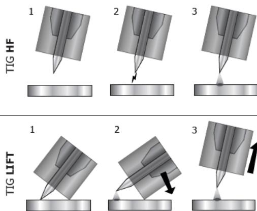
1. Coloque la antorcha en posición de soldadura por encima de la pieza (distancia de unos 2-3 mm entre la punta del electrodo y la pieza).
