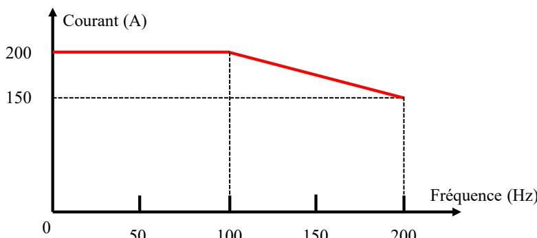
Jusqu'à 100 Hz, il est possible de souder à un courant de soudage de 200 A. Entre 100 Hz et 200 Hz, la valeur maximale du courant de soudage décroît de 200 A à 150 A.
