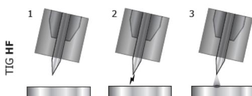
1. Plaats de toorts in de laspositie boven het te lassen werkstuk (ongeveer 2-3 mm tussen de punt van de elektrode en het werkstuk).
