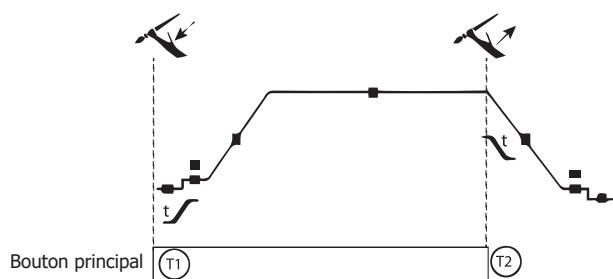
T1 : Le bouton principal est appuyé, le cycle de soudage démarre (Pré-Gaz, I\_start, UpSlope et soudage).
