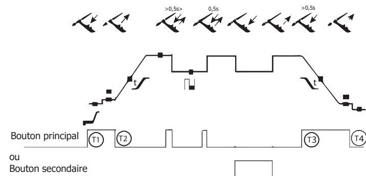
T1 : Die Haupttaste wird gedrückt, der Schweißzyklus beginnt mit der Gasvorströmung und endet mit I\_start.
