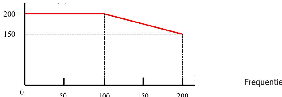
Tot 100 Hz is het mogelijk te lassen met een lasstroom van 200 A. Tussen 100 Hz en 200 Hz valt de waarde van de lasstroom terug van 200 A tot 150 A...
