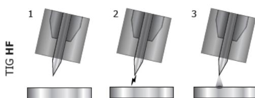
1. Placer la torche en position de soudage au-dessus de la pièce (écart d'environ 2-3 mm entre la pointe de l'électrode et la pièce).
