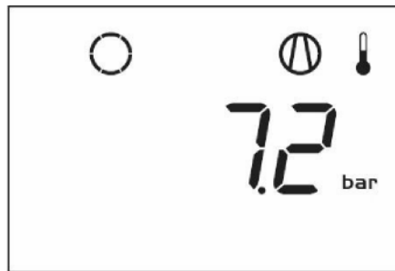
Hoofdpagina met aanduiding alarmstop, uitlaattemperatuur compressorelement
