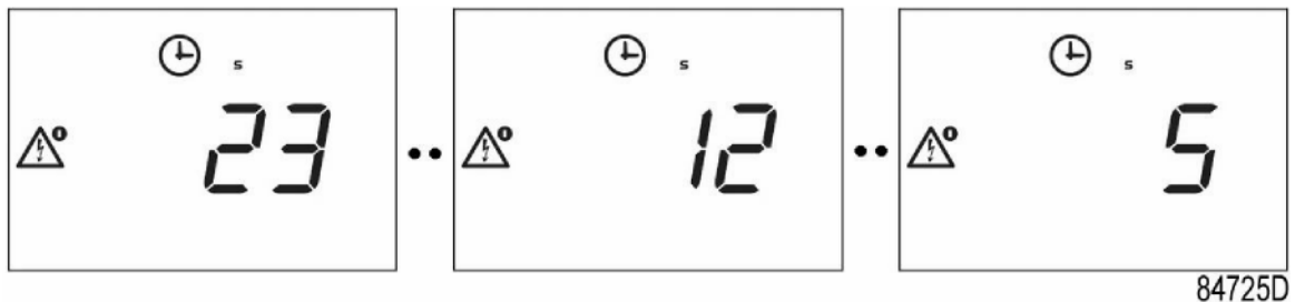
Voorbeeld countdown vertragingstijd van de automatische start na een stroomuitval.
