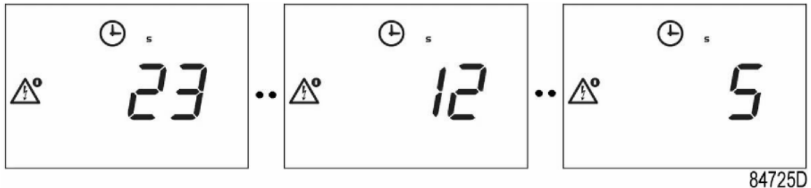
Exemple de délai de compte à rebours du redémarrage automatique après une panne de courant.
