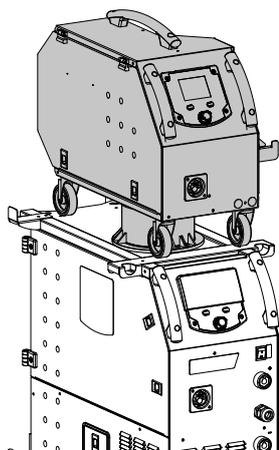
Le produit ARKAD 400T DUO peut-être équipé d'un dévidoir séparé WF 35 (option, ref. 077614) afin d'utiliser rapidement 2 natures ou diamètres de fils sans changer de torches ou de bobines. La liaison entre ces deux éléments se fait par l'intermédiaire d'un faisceau dédié en option :
