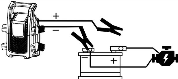
Entfernen Sie den roten Clip (+) von der an der Batterie befestigten Klemme.
