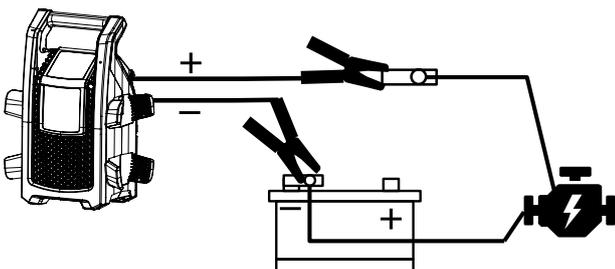
Maak de (+) pool los van uw accu en sluit de rode (+) klem van de GYSCAP 680E erop aan.
