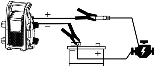
Desconecte el terminal (+) de su batería y conecte la abrazadera roja (+) del GYSCAP 680E.
