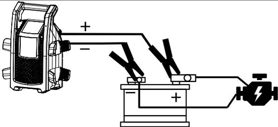
Замените узел: клемма и красный (+) зажим на клемме (+) аккумулятора.
