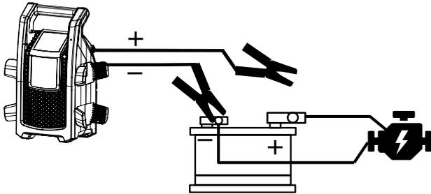
Retire el clip rojo (+) del terminal conectado a la batería.
