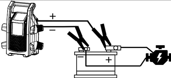
Vervang de assemblage: klem en rode (+) klem op de (+) accupool.
