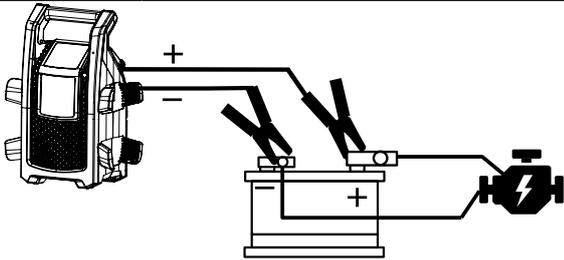
Vuelva a colocar el conjunto: terminal y clip rojo (+) en el terminal de la batería (+).
