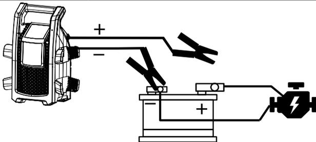
Снимите красный зажим (+) с клеммы, прикрепленной к батарее.
