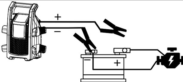
Verwijder de rode klem (+) van de klem die aan de batterij is bevestigd.
