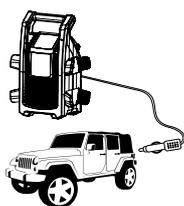
Raccorder le câble allume-cigare du GYSCAP 680E à un véhicule.
