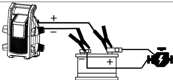
Sostituire il gruppo: morsetto e clip rossa (+) sul morsetto della batteria (+).
