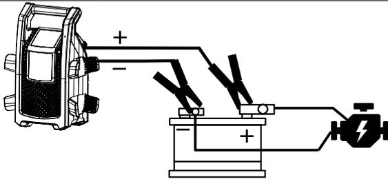
Setzen Sie die Baugruppe wieder ein: Klemme und rote (+) Klemme auf den (+) Batteriepol.
