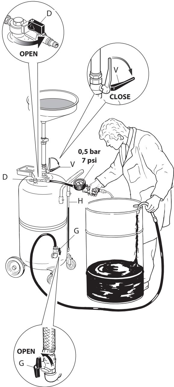
**LEDIGEN VAN DE UNIT (fig. 8)****OPGELET:** Sluit nu de kraan **V** aan de onderzijde van de opvangschaal.Plaats de afvoerslang in een vat op de bulktank. Sluit perslucht met een gereduceerde druk **D** van 0,5 bar-7 psi aan op de luchtaansluiting Den open daarna de kraan **G** aan de onderzijde van de tank. Nadat de tank is leeg geperst moet de kraan **G** weer gesloten worden.
