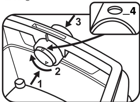
Pousser la bride sur la tubulure d'aspiration, rabattre l'ouverture supérieure du sac sur le bord du contenant.
