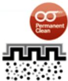
Le filtre intelligent, électromagnétique nettoie le filtre seulement quand la puissance d'aspiration diminue et quand la capacité désirée n'est pas atteinte. Le 'Permanent Clean System' révisé mesure constamment la pression du courant d'air avant et après le filtre. De cette façon, on évite que le nettoyage est fait quand le tuyau est bloqué ou le diamètre du tuyau d'aspiration est trop étroit.
