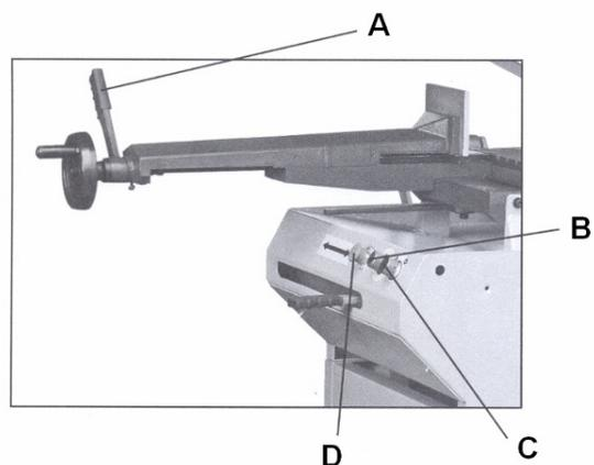
Le cylindre est idéal pour couper des barres d'acier inoxydable. Le ruban descend constamment et obtient un rendement élevé. Réglez la valve hydraulique (B) pour adapter ce système aux situations et applications différentes. Une baisse de la force de frein ou l'évaporation du liquide de frein à long terme peut endommager le système.
