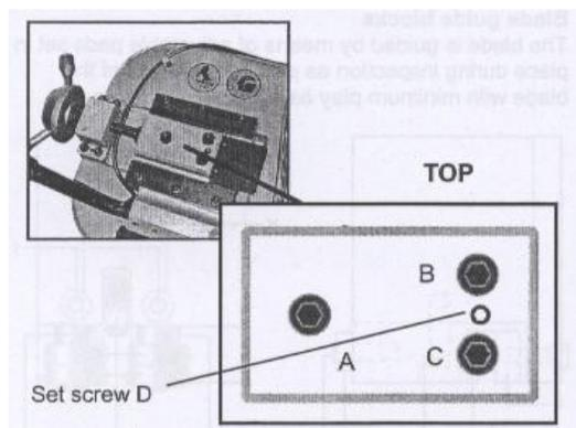
1. Desserrez les vis A, B et C.
