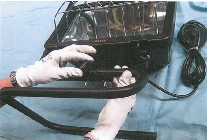
FOTO 4) SCHUIF DE VLOERSTEUN IN DE HULS EN SCHROEF DE KNOP TERUG IN DE GEWENSTE POSITIE.
