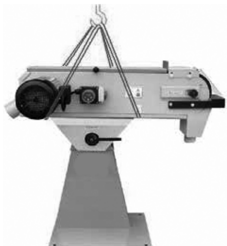
2 Transport de la machine avec une grue après déballage
