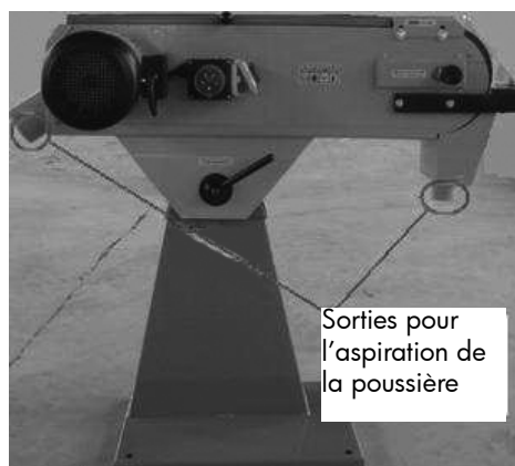
Fig. 5-3 Aspiration de la poussière
