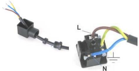
9. Placez le joint du connecteur sur le connecteur, branchez le connecteur sur la minuterie comme illustré ci-dessous et serrez la vis (couple maximal 1Nm). Veillez à ce que les deux joints soient bien fixés pour garantir l'indice IP65.
