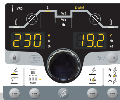
Interface utilisateur à double afficheur avec bouton rotatif et poussoir pour un réglage rapide des paramètres
